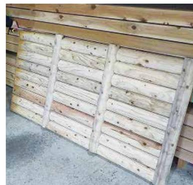
→型枠パネル1枚は縦・横0.9×1.8m、丸棒加工した木材を半割り状にして使用、縦・横を組み合わせパネル状に形成。
